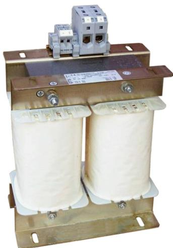
La denominazione a "**COLONNE**" indica la distribuzione degli avvolgimenti su due colonne. Tale soluzione consente l'impiego di nuclei magnetici di sezione ridotta (con conseguente limitazione delle correnti di inserzione) e una elevata superficie di dissipazione del calore
